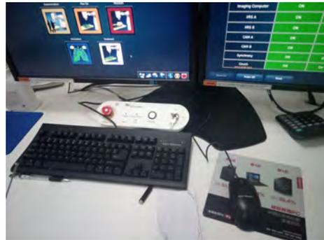
图 2-16 射波刀控制室急停按钮
